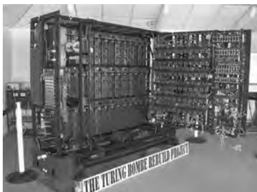
Рис. 18. Вид внутри машины Bombe (музейная реплика 2009 г.).
