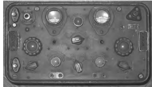
Рис. 23. Военная KV радиостанция РБМ (левая половина — передатчик, правая — приемник).
